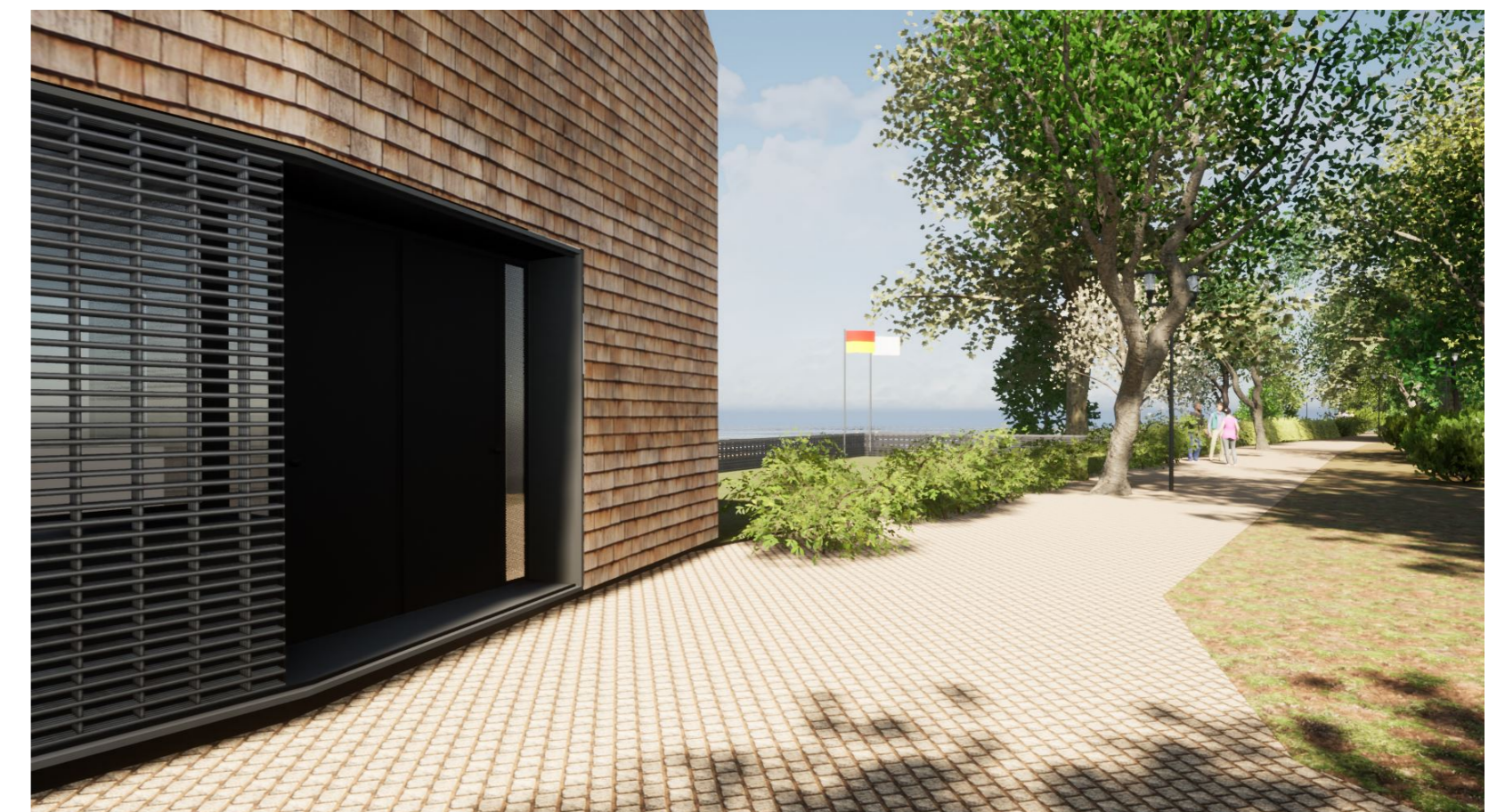
Promenadeneingang DLRG Wasserrettung + Büroraum mit Schiebeelementen zur Sicherung in der Winterzeit.
